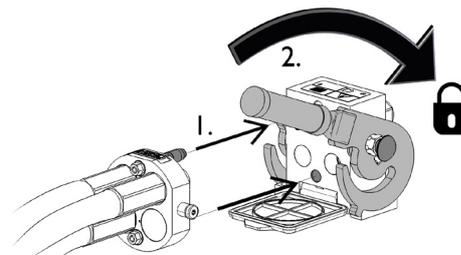
La leva deve potersi muovere facilmente fino alla posizione di bloccaggio. Se la leva non scorre in modo fluido, controllare l'allineamento e la posizione del connettore e pulire i connettori. Spegnerne anche la pala caricatrice e rilasciare la pressione idraulica residua.
